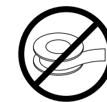
L'utilisation d'adhésif à tuyauterie n'est pas recommandée.
