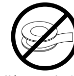
L'utilisation d'adhésif à tuyauterie n'est pas recommandée.
